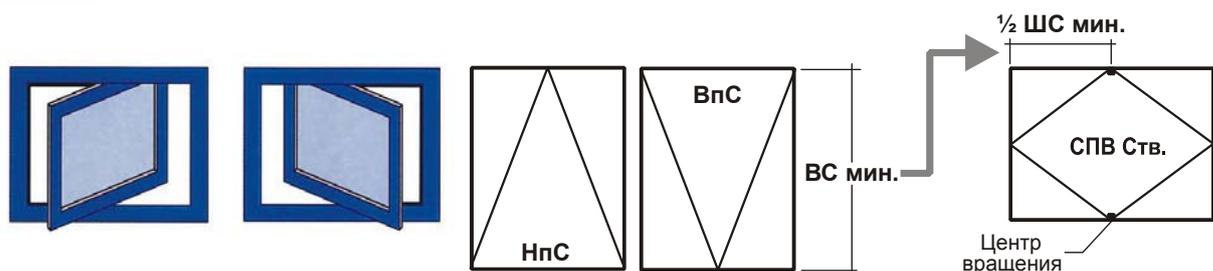
4.2 Монтаж привода KSL с K 94 и F21 у НпС или ПовС, открывающихся внутрь, монт. размер: мин. 17 мм
