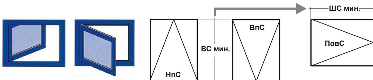
**Среднеповоротная вокруг горизонтальной оси :** Размер *минимальная высота створки (ВС мин.)* это размер только до центра вращения среднеповоротной створки, вращающейся вокруг горизонтальной оси:
