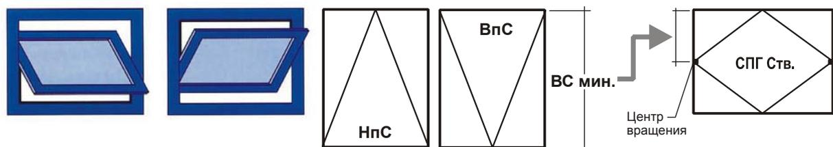
**Среднеповоротная вокруг вертикальной оси :** Размер *минимальная высота створки (ВС мин.)* это размер ширины (1/2 ШС мин.) створки до центра вращения среднеповоротной створки:
