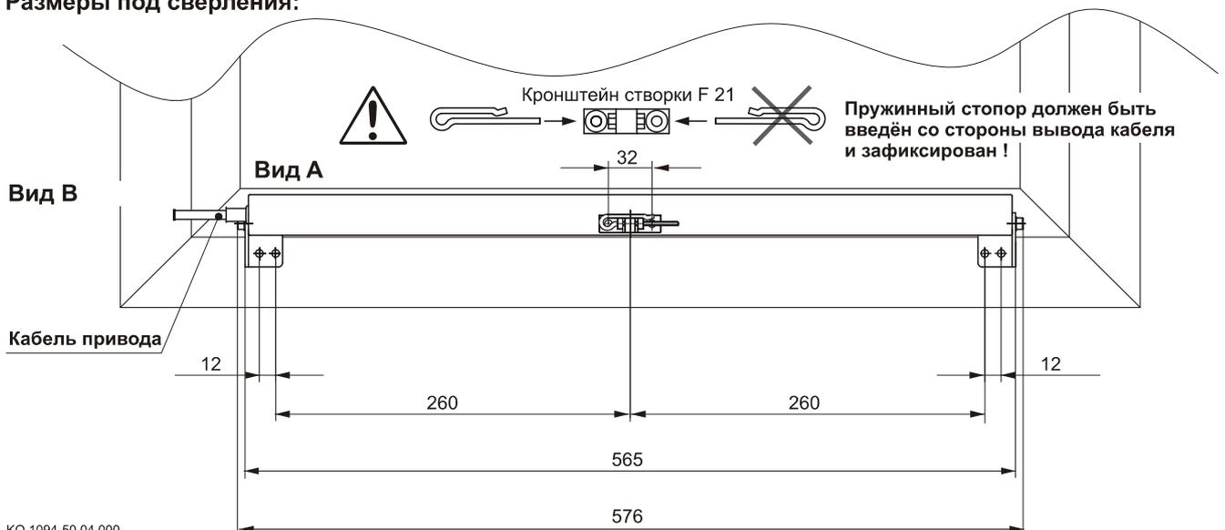
4.8 Монтаж привода KSL с K 94 и F 21 у ВпС или у ПовС, открывающейся наружу с защитным профилем
