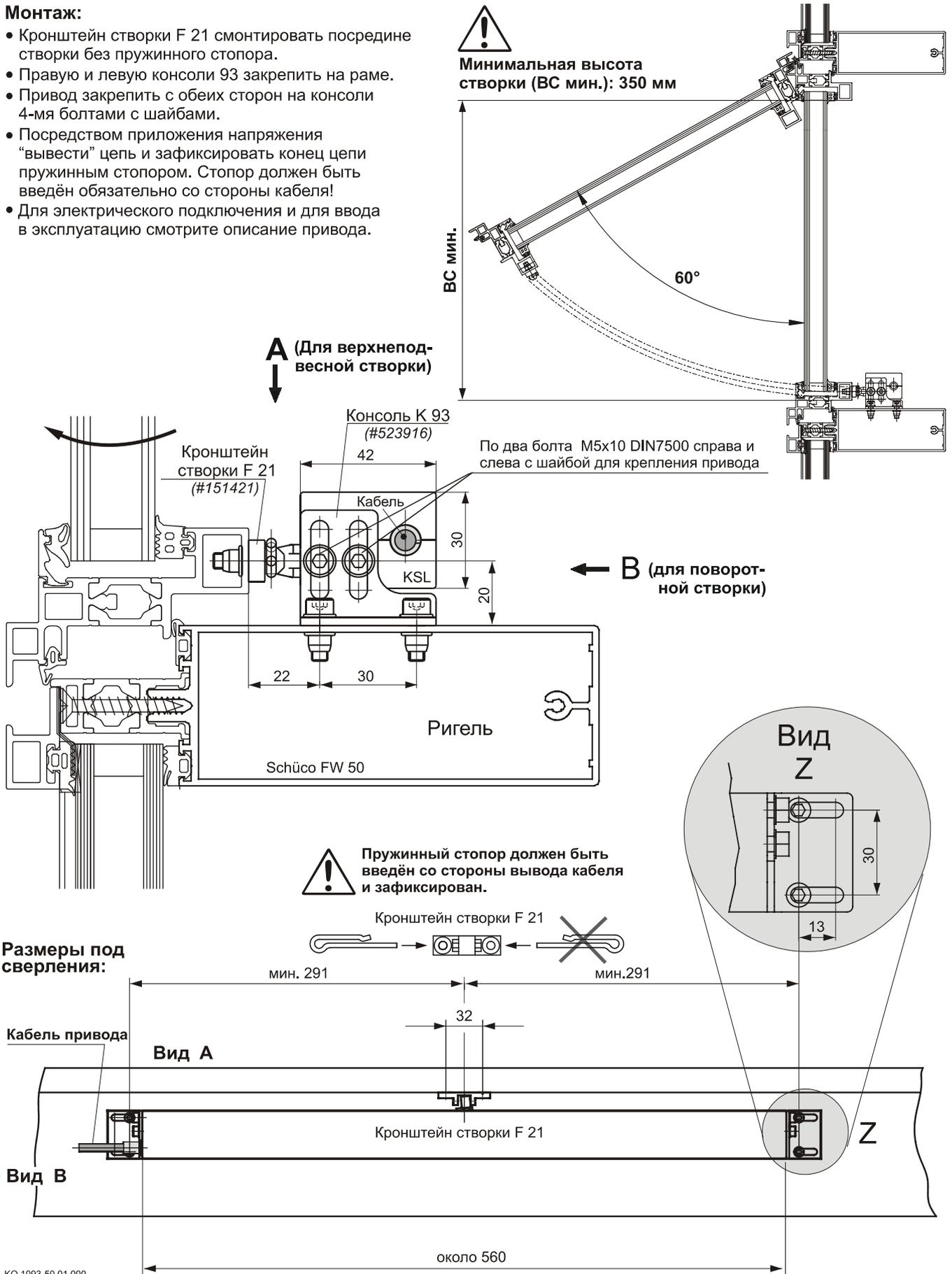
4.10 Монтаж привода KSL с K 93 и F 21 у ВпС или ПовС, открывающейся наружу, с защитным профилем
